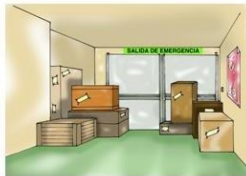
colocar obstáculos en una salida de emergencia
