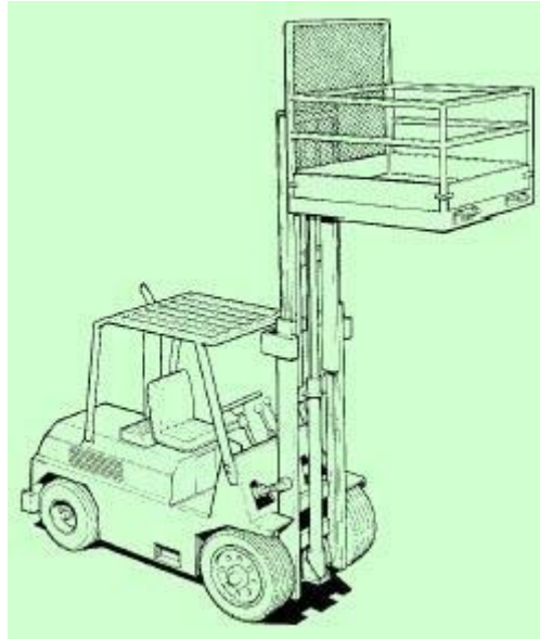
Figura 6: Vista general de un conjunto plataforma-carretilla elevadora
