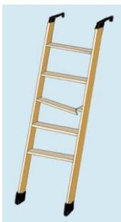
**Factores técnicos:** se refiere a todo el conjunto de condiciones materiales (equipos de trabajo, instalaciones, maquinaria) que puede originar situaciones de peligro y de riesgo para la salud, y pueden ser causa de accidentes. Por ejemplo: presencia de una escalera portátil inestable y en mal estado que se utiliza con frecuencia en el lugar de trabajo.
