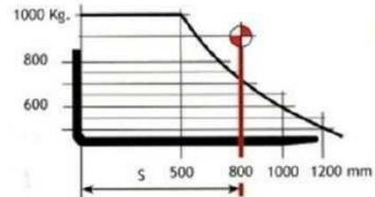
Evite la sobrecarga debida a una excesiva distancia (S) entre el centro de gravedad y el mástil.
