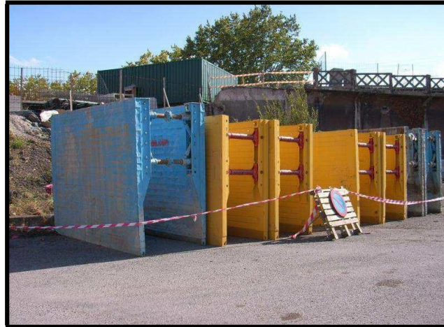
Paneles de entibación
