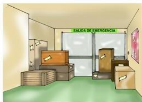
colocar obstáculos en una salida de emergencia
