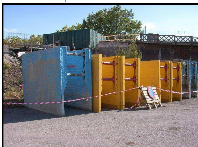
Paneles de entibación
