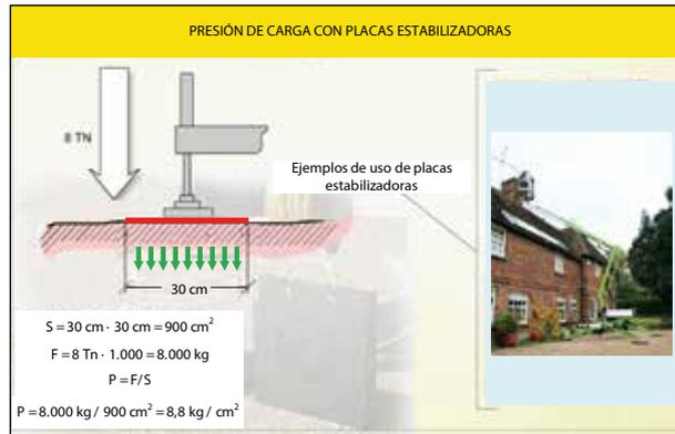
Figura 25. Presión de carga ejercida sobre la superficie de apoyo con y sin placas estabilizadoras.
