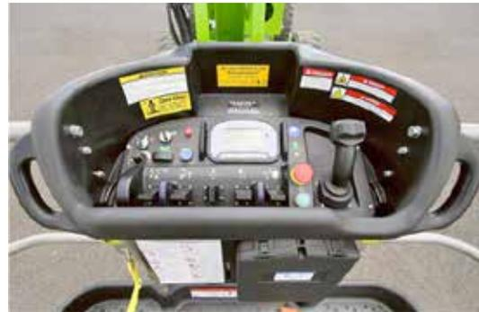
Figura 10. Mando primario sobre plataforma de trabajo.
