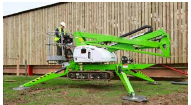
Figura 15. Estabilizadores hidráulicos con placa de apoyo.
