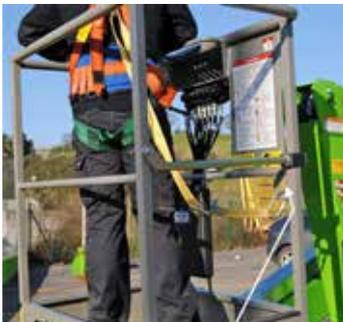
Figura 7. Punto de anclaje para el arnés de seguridad.
