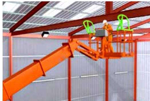
Figura 26. PEMP con sistema antiatrapamiento.
