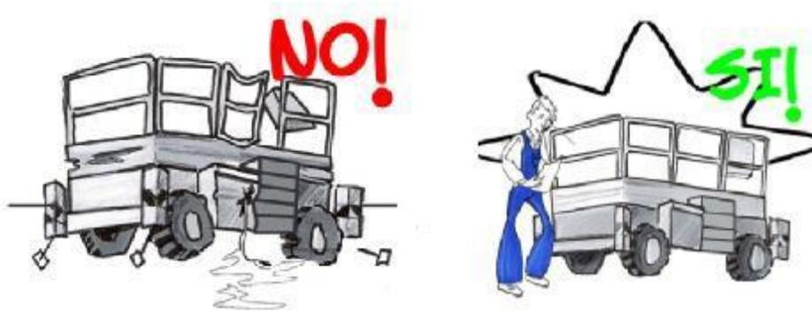
Los estabilizadores deben encontrarse en buen estado y funcionar correctamente así como disponer de protección lateral en todo el perímetro de la plataforma, especialmente en la puerta de acceso.
