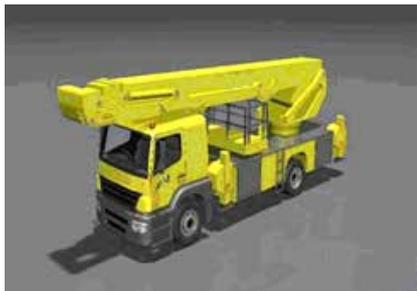
Figura 4. PEMP sobre camión
