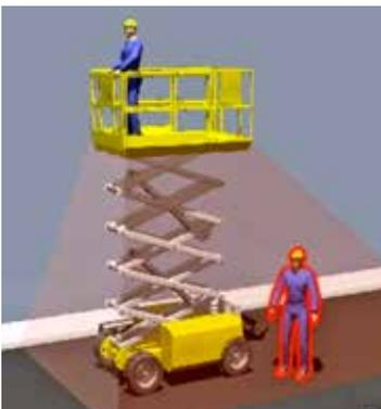
Figura 22. Control de presencia de operarios en proximidad.
