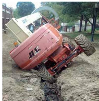
Figura 15. Vuelco por no respetar la distancia de seguridad respecto a una zanja
