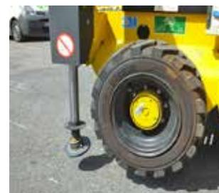
Figura 2. Base de apoyo de un estabilizador.
