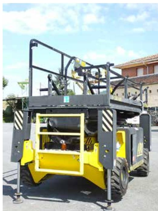
Figura 6. Plataforma de trabajo con protecciones perimetrales plegables.
