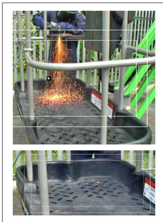
Figura 5. Base de la plataforma de trabajo autoextinguible.
