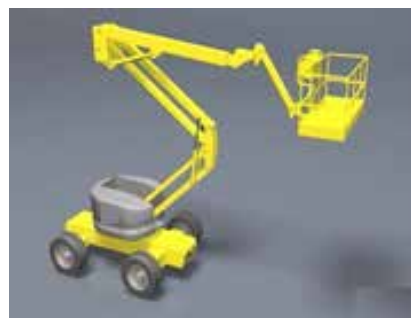
Figura 6. PEMP de estructura articulada
