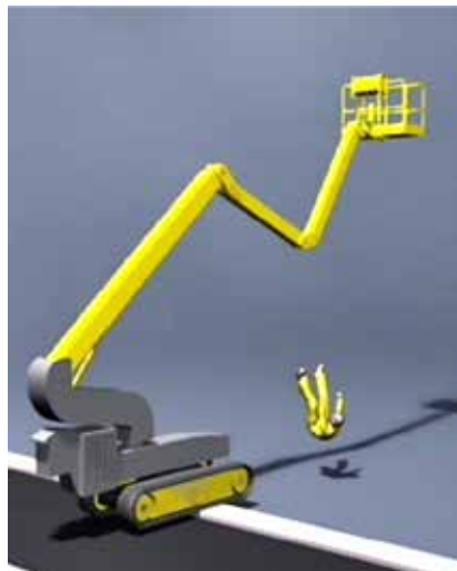
Figura 12. Caída por efecto catapulta
