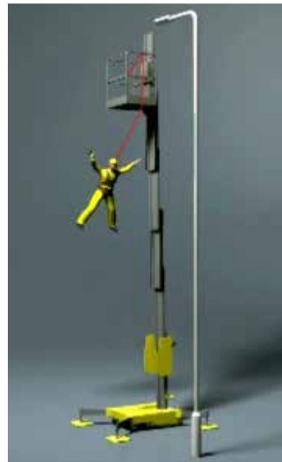
Figura 14. Caída con efecto péndulo
