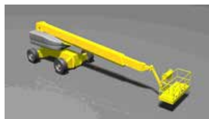
Figura 7. PEMP de estructura telescópica
