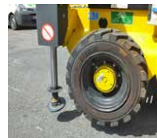
Figura 2. Base de apoyo de un estabilizador.
