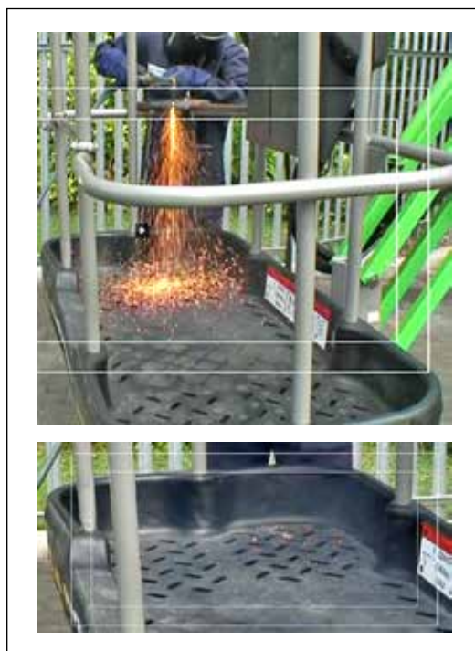
Figura 5. Base de la plataforma de trabajo autoextinguible.
