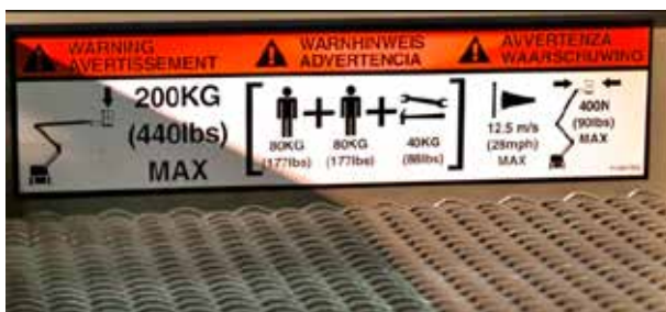
Figura 9. Señalización de carga nominal, número máximo de personas y equipo de trabajo, velocidad máxima del viento y punto de anclaje solo para retención.
