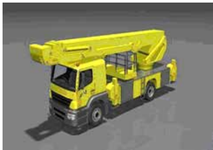
Figura 4. PEMP sobre camión
