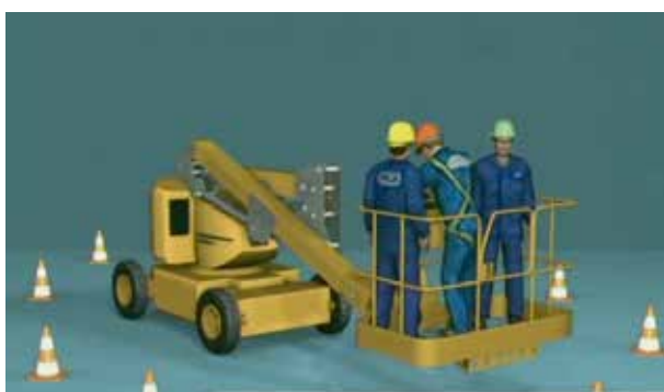
Figura 18. Plataforma de trabajo con exceso de personas
