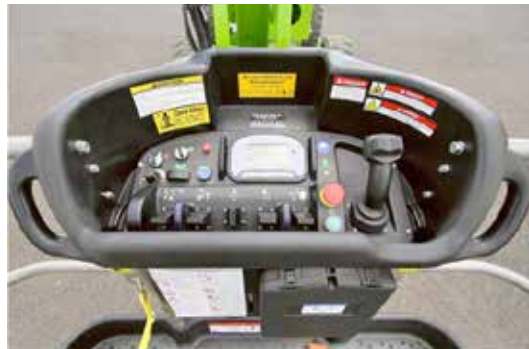
Figura 10. Mando primario sobre plataforma de trabajo.
