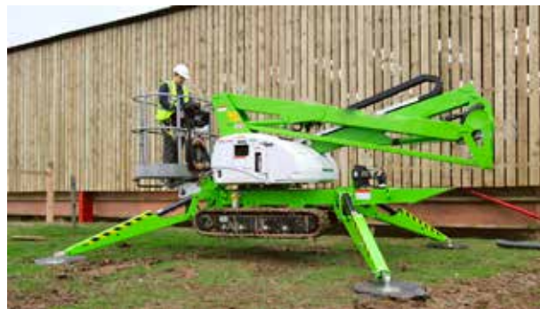
Figura 15. Estabilizadores hidráulicos con placa de apoyo.
