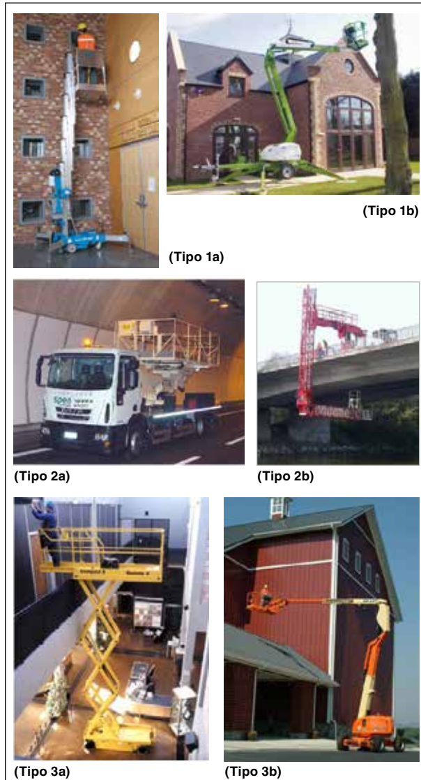
Figura 1. Tipos de PEMP
