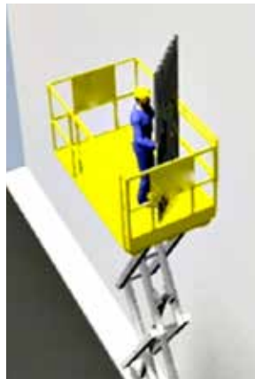
Figura 28. Aumento de la resistencia al viento.
