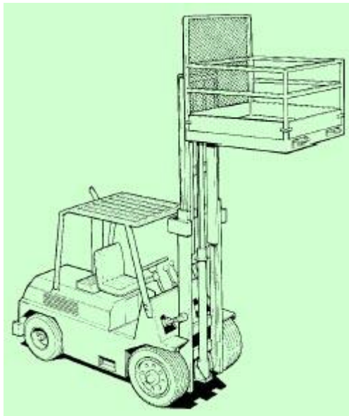
Figura 6: Vista general de un conjunto plataforma-carretilla elevadora
